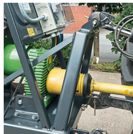
Das Kemper-Getriebe ist auf die Motorkennlinie moderner Schlepper abgestimmt, so dass der Motor mit der 1000er Zapfwelle im Optimum betrieben werden kann.
