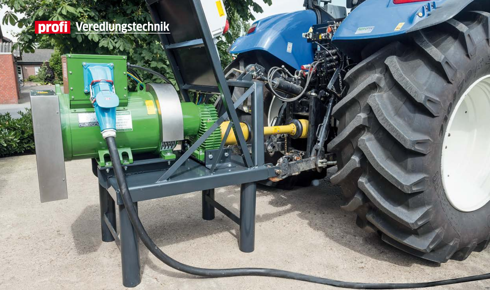
Für landwirtschaftliche Betriebe mit leistungsstarken Stromabnehmern bietet Kemper nun auch ein Aggregat mit 150 kVA Leistung an. Fotos: Tovornik
