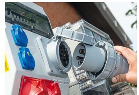
Der linke Kasten beinhaltet die Steckdosenverteilung mit 2 x 230 Volt, 1 x 16 und 1 x 32 Ampere. Die große „1-Uhr-Dose“ dient der Hauseinspeisung mit einem speziellen Stecker (H07RN-F), der zusammen mit 9 m Kabel zum Lieferumfang gehört.
