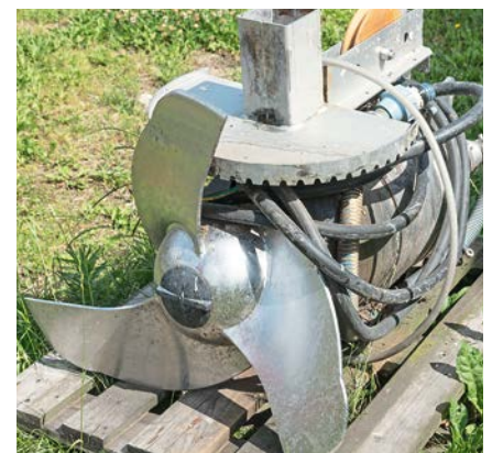
Auch wenn wie hier die Nennstromaufnahme eines R hrwerks mit 13 kW niedrig erscheint, kann mit 44 Ampere die Stromaufnahme hoch sein. Ein Leistungsschalter vor dem Generator sch tzt hier vor einem Kurzschluss, parallel bewirkt er einen sicheren Anlauf des Ger ts.
