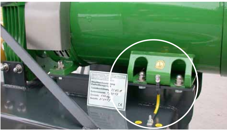
Erdungsklemme: Der Anschluss erfolgt an die Hausanschlussschiene oder an einen Erdungsspieß beim Feldeinsatz.
