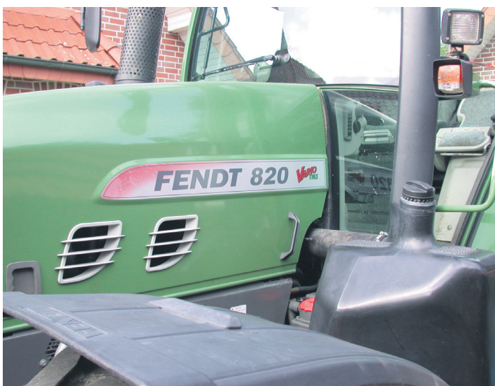
Schlepperleistung und Notstromaggregat müssen zusammenpassen. Es werden 25 % Reserveleistung empfohlen.
