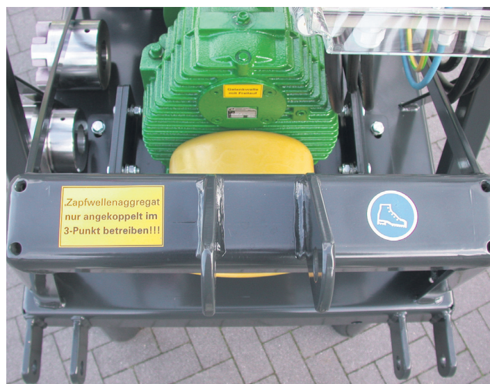
Aufbau eines Zapfwellenaggregates: Der Generator ist auf einem Gestell mit Dreipunktaufhängung montiert.
